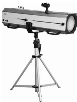
GTD-1500FS. Прожектор следящего света; рабочая дистанция 15-60 м; лампа **OSRAM SharXS HTI 1500W/D7/60**; угол луча 4°-8°; мех. диммер 0-100%; 3 дискретных светофильтра; плавная цветокоррекция СТО; ирис; слот для установки 1 фикс. гобо или светофильтра; коллиматорный прицел; активное охлаждение; встроенный электронный балласт: ~200-240 В, 50/60 Гц, 1,74 кВт; штатив в комплекте. ВхШхГ (макс., с лирой, без штатива): 471x536x1411 мм, масса со штативом 58 кг, от -10 до 45°C, IP20.
