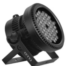
GTD-LZ354P. Управляемый PAR-прожектор; **монохромные светодиоды 54x3 Вт** (красный, зелёный, синий, белый); угол луча 9°-32° при 50% яркости (моторизированный); диммер 0-100%, 8/16-бит; строб. 1-25 всп./с; смешение цветов RGB+W; цветовая температура белого: 7200-3200 К; USITT DMX512-A: 10/16 кан.; пассивное охлаждение; импульсный БП: ~100-240 В, 50-60 Гц, 0,18 кВт. ВхШхГ (макс.): 275x266x198 мм, масса 7,2 кг; от -10 до 45°C, **IP65**.
