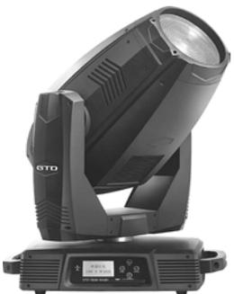
GTD-1500 II WASH. Управляемый автоматизированный прожектор типа WASH; **лампа OSRAM SharXS HTI 1500W/D7/60**; угол луча 6°-34°; диммер 0-100%, 8/16-бит; строб. 1-20 всп./с; CMY + 7+7 дискретных светофильтров; плавная цветокоррекция; 540° PAN; 270° TILT; 8/16 бит; USITT DMX512-A: 16/17/22 кан.; электронный балласт; импульсный БП: ~200-240 В, 50/60 Гц, 1,82 кВт. ВхШхГ(макс.): 780x580x549 мм; масса 38 кг; от -10 до 45°C; IP20.
