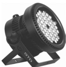
GTD-1254P II. Управляемый PAR-прожектор; **четырёхцветные светодиоды 54x12 Вт** (4-в-1: красный + зелёный + синий + белый); угол луча 19° (27° или 43° по заказу); телевизионный режим; диммер 0-100%, 8/16-бит; строб. 1-25 всп./с; смешение цветов RGB+W; цветовая температура белого: 7200-3200 К; USITT DMX512-A: 8/15 кан.; пассивное охлаждение; импульсный БП: ~200-240 В, 50-60 Гц, 0,17 кВт. ВхШхГ (макс.): 275x266x198 мм, масса 7,5 кг; от -10 до 45°C, **IP65**.
