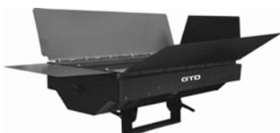
GTD-LYS011764 WW/CW. Управляемый светильник; **светодиоды белого свечения 1764х0,1 Вт** (CRI ≥ 90, 3200 К или 5600 К, 50000 ч); угол луча 78° (10% яркость); диммер 0-100%; USITT DMX512-A: 1 кан.; пассивное охлаждение; импульсный БП: ~100-240 В, 50-60 Гц, 0,17 кВт. ВхШхГ (макс., с лирой): 335х791х146 мм, масса 10 кг, от -10 до 45°C, IP20.
