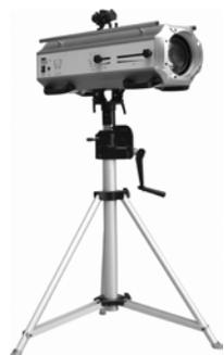
GTD-330FS. Прожектор следящего света; рабочая дистанция 5-20 м; лампа **OSRAM SIRIUS HRI 330 W XL**; угол луча 6°-12°; мех. диммер 0-100%; 3 дискретных светофильтра; плавная цветокоррекция СТО; ирис; слот для установки 1 фикс. гобо или светофильтра; коллиматорный прицел; активное охлаждение; встроенный электронный балласт: ~100-240 В, 50/60 Гц, 0,38 кВт; штатив в комплекте. ВхШхГ (макс., с лирой, без штатива): 400x240x837 мм, масса со штативом 28 кг, от -10 до 45°C, IP20.
