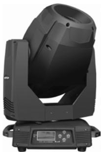
GTD-461 II BEAM. Управляемый автоматизированный прожектор типа BEAM; лампа **OSRAM SIRIUS HRI 461W**; фрост-фильтр, мотор. фокус; 2 вращ. призмы с зумированием; диммер 0-100%; строб. 1-20 всп./с; 14 дискретных светофильтров, вкл. УФ и фильтры цветокоррекции; 12 вращ. + 16 фикс. гобо с пульсацией; 540° PAN, 270° TILT, 8/16 бит.; USITT DMX512-A: 17/20/23 кан.; электронный балласт; импульсный БП: ~100-240 В, 50/60 Гц, 0,78 кВт. ВхШхГ (макс.): 707x437x471 мм, масса 28 кг; от -10 до 45°C; IP20.
