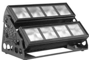
GTD-L488. Управляемый циклограмный светильник; **монохромные светодиоды 8x48 Вт** (красный, зелёный, синий, белый, янтарный); угол луча 73° (10% яркость); диммер 0-100%; строб. 1-25 всп./с; смешение цветов RGB+W+A; цветовая температура белого: 7200-3200 К; USITT DMX512-A: 8/14 кан.; пассивное охлаждение; импульсный БП: ~100-240 В, 50-60 Гц, 0,31 кВт. ВхШхГ (макс.): 350x565x313 мм, масса 16 кг, от -10 до 45°С, IP20.
