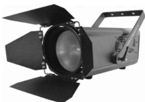
GTD-LYS200 WW/CW. Управляемый прожектор с линзой Френеля; **светодиод белого свечения 200 Вт** (CRI ≥ 90, 3200 К или 5600 К, 50000 ч); угол луча 18°-58° (ручная регулировка); диммер 0-100%; USITT DMX512-A: 1 кан.; активное охлаждение; импульсный БП: ~100-240 В, 50-60 Гц, 0,21 кВт. ВхШхГ (макс., с лирой): 417х347х473 мм, масса 7,5 кг, от -10 до 45°C, IP20.
