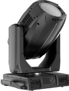
GTD-1400 II WASH. Управляемый автоматизированный прожектор типа WASH; лампа **OSRAM Lok-it! 1400/PS Brilliant** (CRI ≥ 95, 6000 K, 750 ч); угол луча 5°-65°; диммер 0-100%, 8/16-бит; строб. 1-20 всп./с; CMY + 6+6 дискретных светофильтров; плавная цветокоррекция CTO; 540° PAN; 270° TILT; 8/16 бит; USITT DMX512-A: 14/16/22 кан.; электронный балласт; импульсный БП; ~200-240 В; 50/60 Гц, 1,81 кВт. ВхШхГ (макс.): 764x571x558 мм; масса 39 кг; от -15 до 45°C; IP20.
